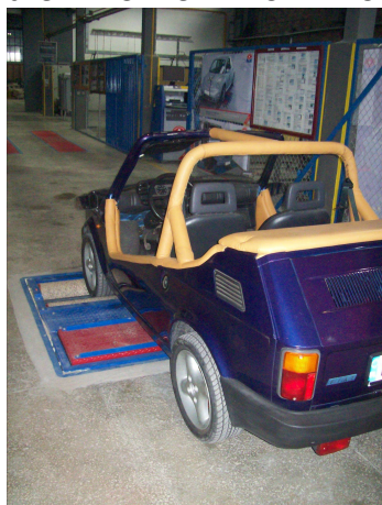
Rys. 4. Widok urządzenia diagnostycznego IW2 Allrad MAHA: a - rolki pomiarowe, b – pulpit z wizualizacją wyników i drukarką.
