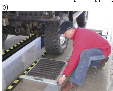
Rys. 6 Badanie skuteczności układu hamulcowego przy stałych układach napędowych 4x4: a – poprzez naklejanie pasków do oceny luzu międzyzębnego, b – poprzez zastosowanie WSOP Rollera
