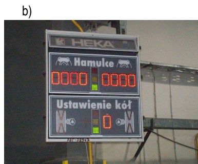
Rys. 7. Widok urządzenia diagnostycznego HEKA UNIVERS A4: a - płyty pomiarowe, b – pulpit z wizualizacją wyników i drukarką.
